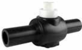
PE BALL VALVE (REDUCED BORE) PE KÜRESEL VANA (REDÜKSİYON GEÇİŞ) SDR11 PE100 GAS/GAZ : 10 BAR WATER/SU : 16 BAR
