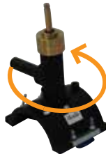
360° ROTATING OUTLET TAPPING TE 360° DÖNER BAŞLIKLILIKLI VANALI SERVİS TE SDR 11 PE100 GAS / GAZ : 10 BAR WATER / SU : 16 BAR
