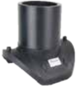
EF FLEX SADDLE EF FLEKS SEMERİ SDR11 PE100 GAS / GAZ : 6 BAR WATER / SU : 16 BAR
